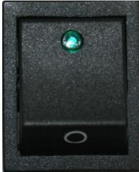
Abb. 53: Netzschalter
