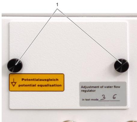
1. Die Abdeckung durch Lösen der beiden Rändelschrauben (1) entfernen.
