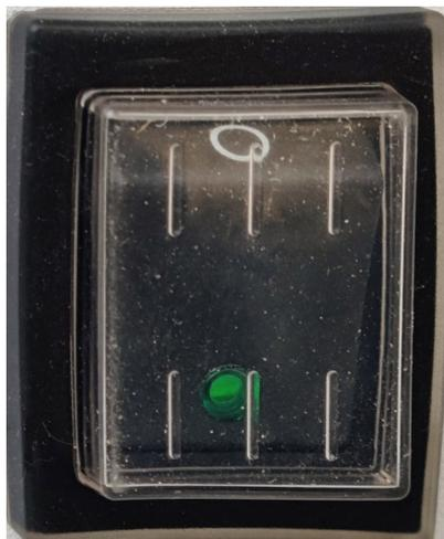
Abb. 18: Netzschalter mit Spritzschutzkappe
